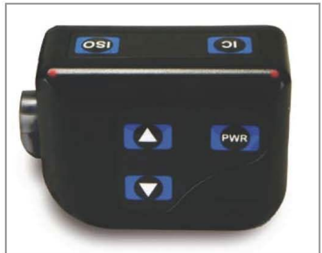
Das kompakte und sehr leichte Beltpac mit versiegelten Tasten mit Li-Ionen Akku und innen liegender Antenne.
